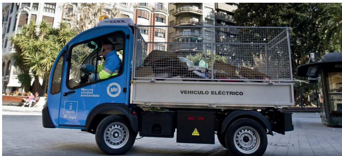
Vehículo eléctrico de recogida de basura
